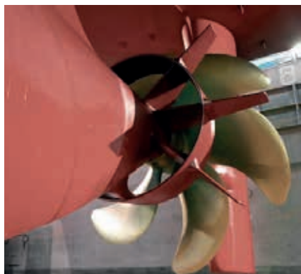
照片顯示預旋葉片 (PSV) 及水流預旋導管、螺旋槳螺帽葉片及矽油漆螺旋槳
