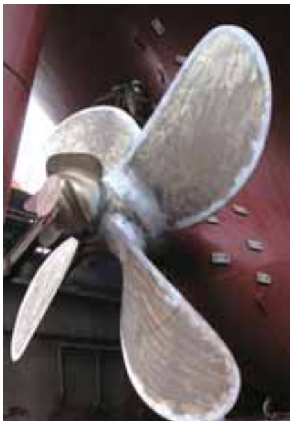
採用螺旋槳螺帽葉片提高了本集團自有貨船的燃料效能
