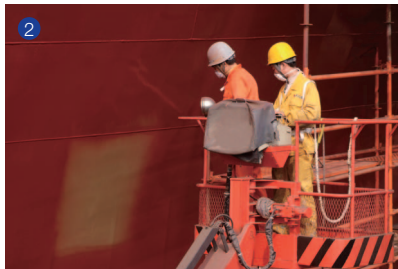
2 我們在船體的夏季載重綫以下塗上低摩擦防污塗料，以減低船體水流阻力
